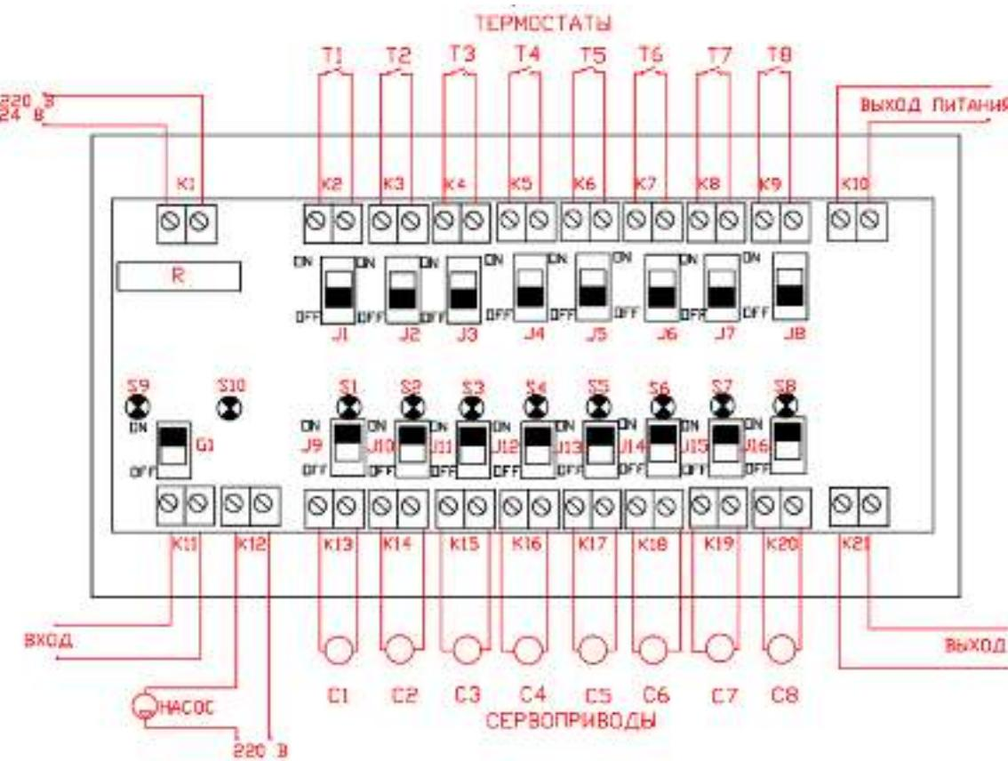
4.2.5. Сервоприводы С1-С8 подключаются к клеммным парам К13-К20. При положении ON переключателей J1-J8 управляющий сигнал от клеммной пары термостата передаётся на клеммную пару сервопривода, расположенную напротив (К2-К13;К3-К14;К4-К15;К5-К16;К6-К17;К7-К18;К8-К19;К9-К20)
